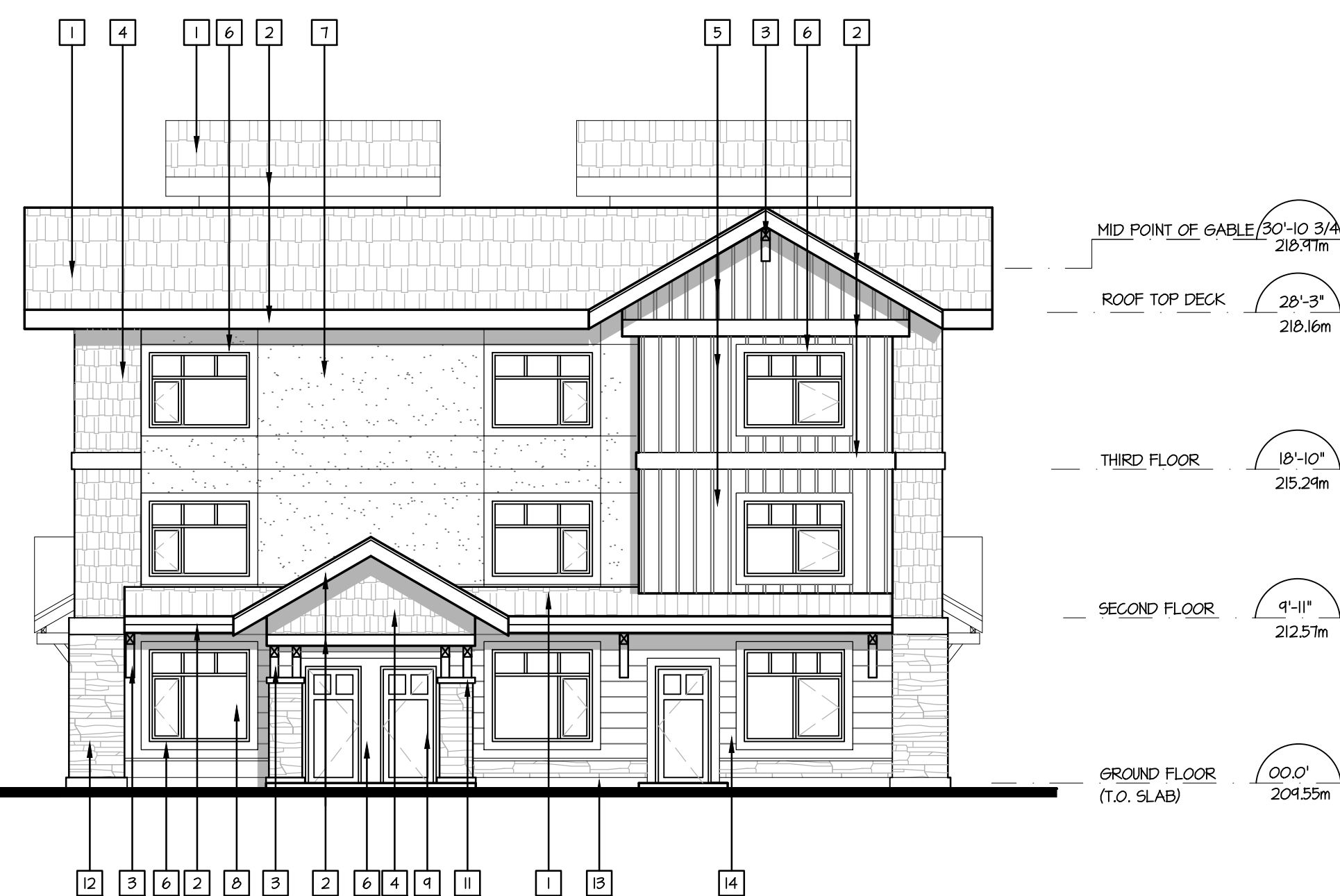
EAST ELEVATION (BUILDING 1) SCALE: 1/8" = 1'-0"
