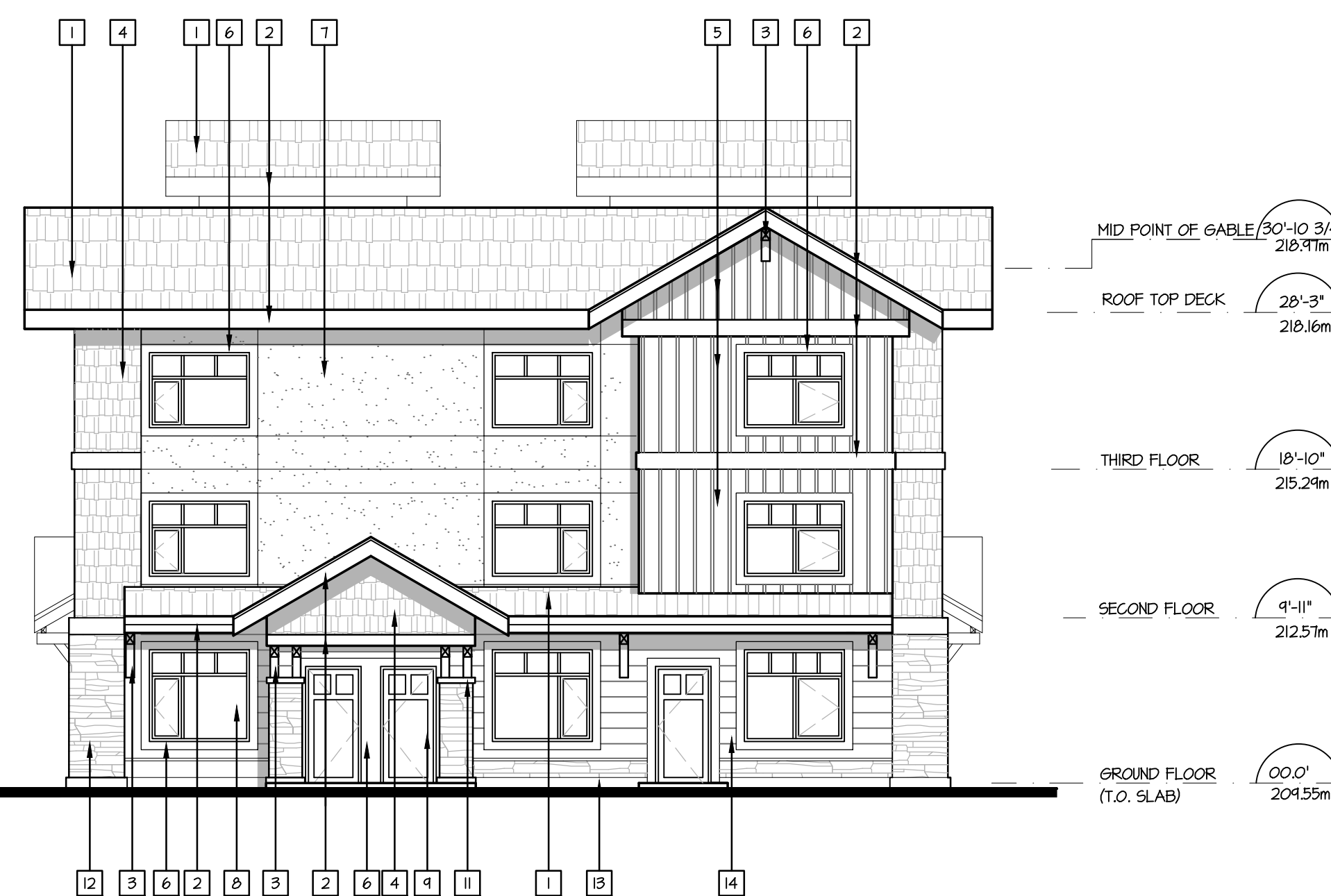
EAST ELEVATION (BUILDING 1) SCALE: 1/8" = 1'-0"
